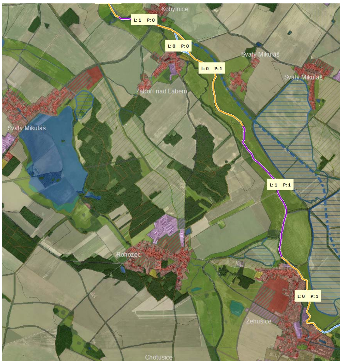
Obrázek 15 Identifikace úseků toku s vhodnými podmínkami pro změnu charakteru protipovodňové ochrany v oblasti nivy - úsek toku Doubravy pod Žehušicemi. Legenda: L – levý břeh, P – pravý břeh, 0 – beze změny, 1 – návrh úpravy
